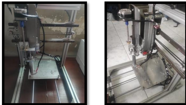
Hình 12. Máy in 3D chocolate được chế tạo thực tế
